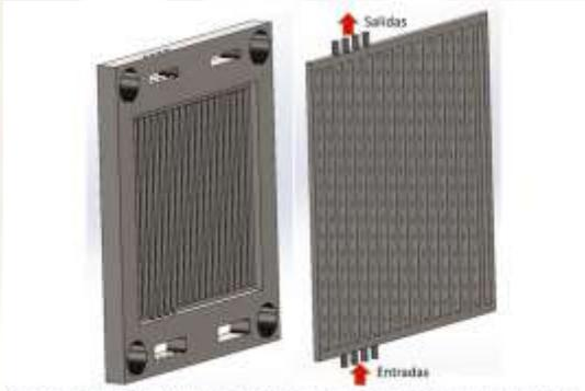
Modelo CAD y volumen interno de Placa Manosajal de Electroizador INEEL, área de 50 cm<sup>2</sup>.
